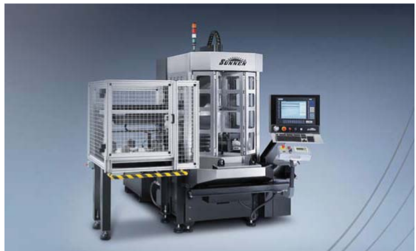
Автоматизированный комплекс на базе хонинговального станка SV-1010
